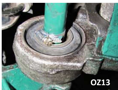
Bild 27 – Sicherung des Torsionsstabes
