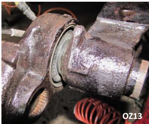
Bild 24 – die fertig montierte Gummibuchse
