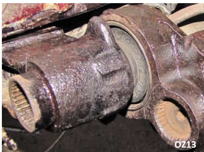
Bild 25 – die montierte linksseitige Buchse mit fixiertem Montagebügel, montiertem Torsionsstab und frei hängendem Längslenker, wobei die Position des letzteren durch den Torsionsstab vorgegeben wird. Beachten Sie die Verdrehung des Gummikörpers der Buchse (man kann das an den Buchstaben erkennen, welche nicht kursiv sind!).
