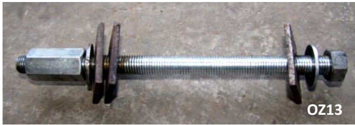
Bild 22 – Werkzeug zum Aufpressen des Montagebügels – ein Stück Gewindestange (M16 oder M18, jedenfalls stark genug), eine Mutter ans Ende geschweißt, eine lange Mutter und Beilagscheiben.
