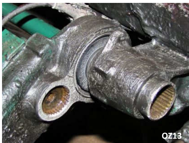
Bild 26 – rechtsseitige Anordnung, fast fertiggestellt. Gleiche Situation wie in Bild 25 (spiegelverkehrt); Beachten Sie die Verdrehung des Gummikörpers der Buchse (die „umgekehrt kursiven“ Buchstaben).
